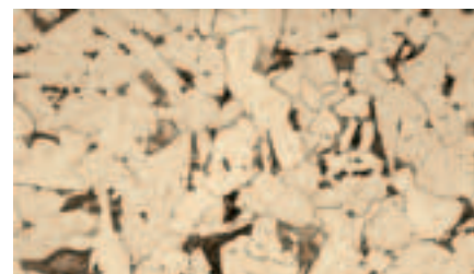
Perlit, Ferrit és Cementit keveréke
