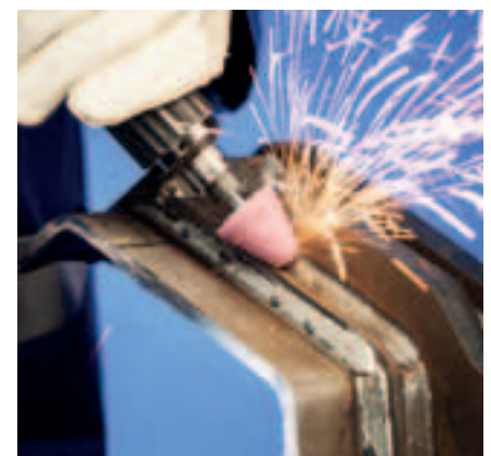
Hegesztési varratok megmunkálása M keménységű csiszolócsappal.
