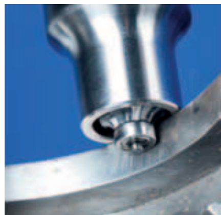
A szegélyek lekerekítése EDGE fogazatú marócsapokkal optimális előkészítést jelent a bevonatolásra.
