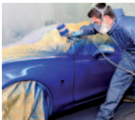
A szennyeződések és az egyenetlenségek csökkentik a védőréteg tapadását. Egy jól megtisztított felület az alapja a tökéletes eredménynek.
