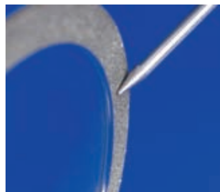
Wolfram hegesztőelektroda csiszolása gyémántszemcsés csiszolókoronggal
