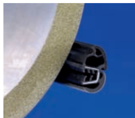
Fémbeételes autóiipari tömítések darabolása gyémánt és CBN szemcsés korongokkal.
