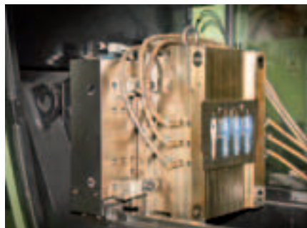
A PFERD ergonomikus reszelőnyeleit fröccsöntéssel készítik.
