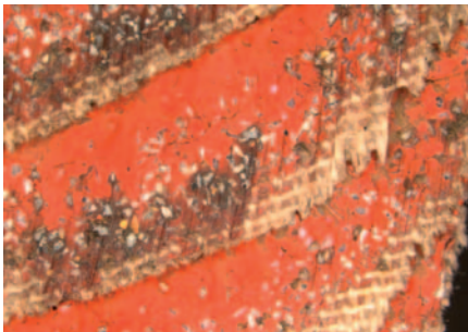
Tipikus kopáskép a karakterisztikus fényes hűtőfilm hatására (nem „elüvegesedés”).
