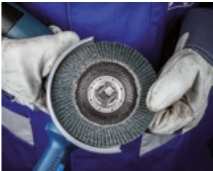
Pozicionálja a szerszámot az X-LOCK-felfogóhoz.
